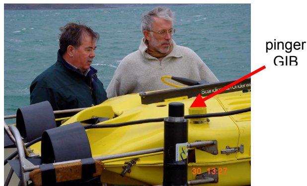
SUTEC ROV & GIB 32 kHz pinger
